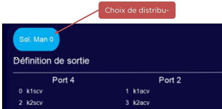
Chaque solénoïde commandé par RF2 est programmable, de façon que l'emplacement de port de chaque signal dépend de l'emplacement programmé pour ce signal.
