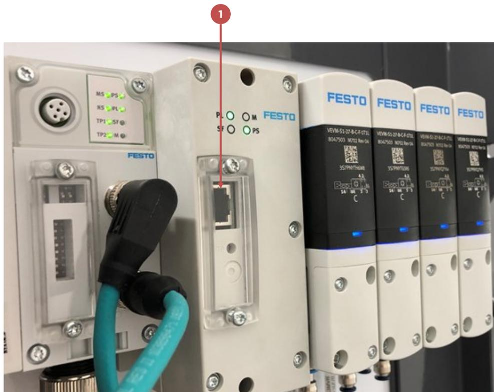
Pour cela - commencez par trouver le port RJ45 (1) utilisé pour la configuration du module VTEM. Connectez un PC à ce port.
