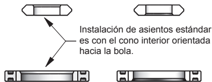
DETALLE "D" ORIENTACIÓN DEL ASIENTO DE LA BOLA INFERIOR (el asiento es reversible)
