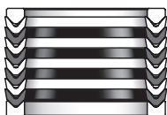
DETALLE "B" ORIENTACIONES DE LA EMPAQUETADURA INFERIOR
